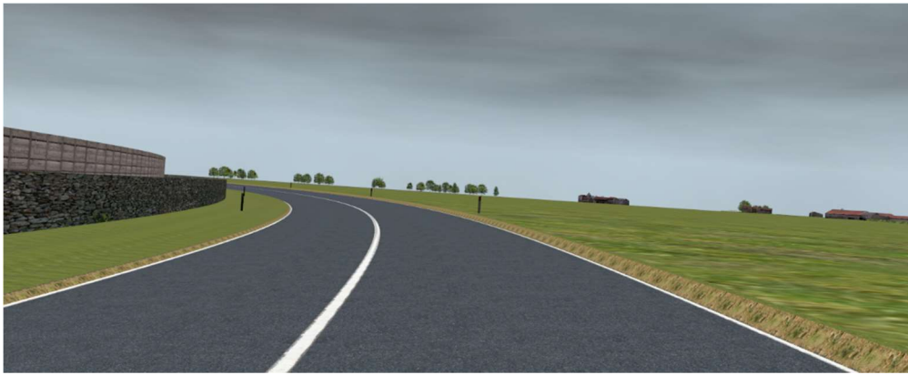
Figura 2.21. Tracciato del test, tratto 3, curva 1 (lunghezza 562 m, raggio 430 m), assenza della banchina
